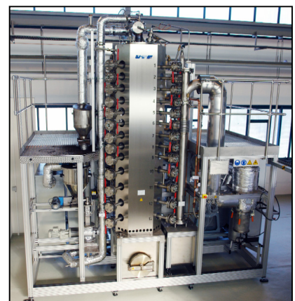
Bild 2 50-kW-Staubfeuerungs-Versuchsanlage für Oxyfuel
